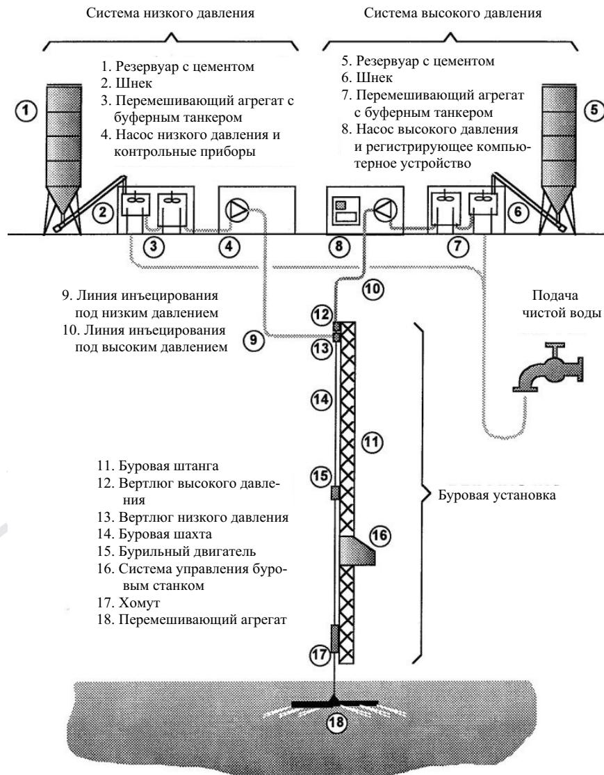
Рис. 8.31. Схема технологии *SSI* и принцип ее работы
