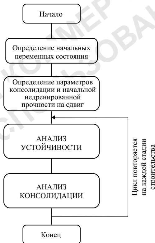
Рис. 2.6. Методология анализа поэтапного строительства
