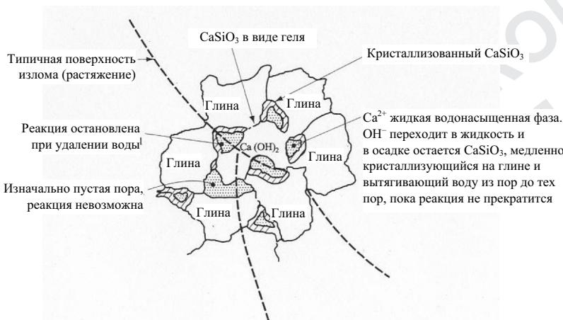
Рис. 8.4. Механизм стабилизации известью (CDIT, 2002)
