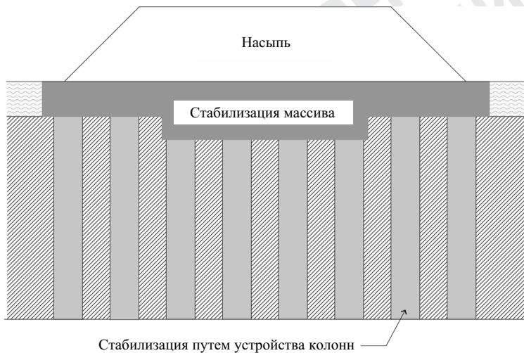
Рис. 8.2. Сочетание стабилизации массива и устройства колонн
