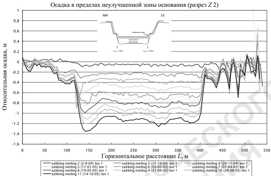
Рис. 9.10. Эпюры осадок в зоне контакта между песком тела насыпи и грунтом основания в неулучшенной зоне
