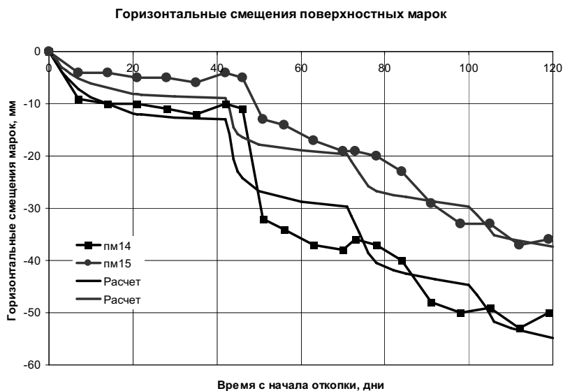
Рис. 9.45. Сравнение развития во времени вертикальных перемещений поверхности грунта на расстоянии 10 м (марка 14) и 15 м (марка 15) от шпунтового ограждения по расчету с использованием упруговязкопластической модели и по результатам натурных наблюдений
