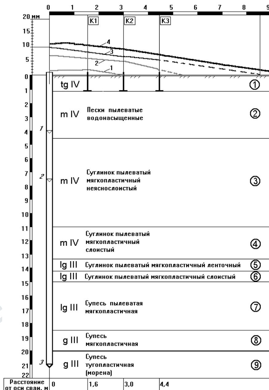
Рис. 8.2. Инженерно-геологические условия опытной площадки и эпюры вертикальных смещений кровли песка при внедрении сваи: 1, 2, 3 – экспериментальные эпюры вертикальных смещений поверхности кровли песка при внедрении сваи соответственно на 4; 7,5 и 21 м; 4 – расчетная эпюра вертикального смещения поверхности кровли песков при внедрении сваи на глубину 21 м
