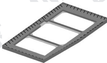
7. Выполнение коробчатой конструкции по всему контуру сооружения и в поперечных траншеях
