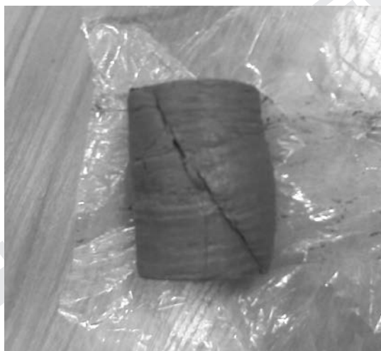
Рис. 4.32. Характер разрушения образца озерно-ледниковых суглинков текучей консистенции ненарушенной структуры при отборе образца из котлована
