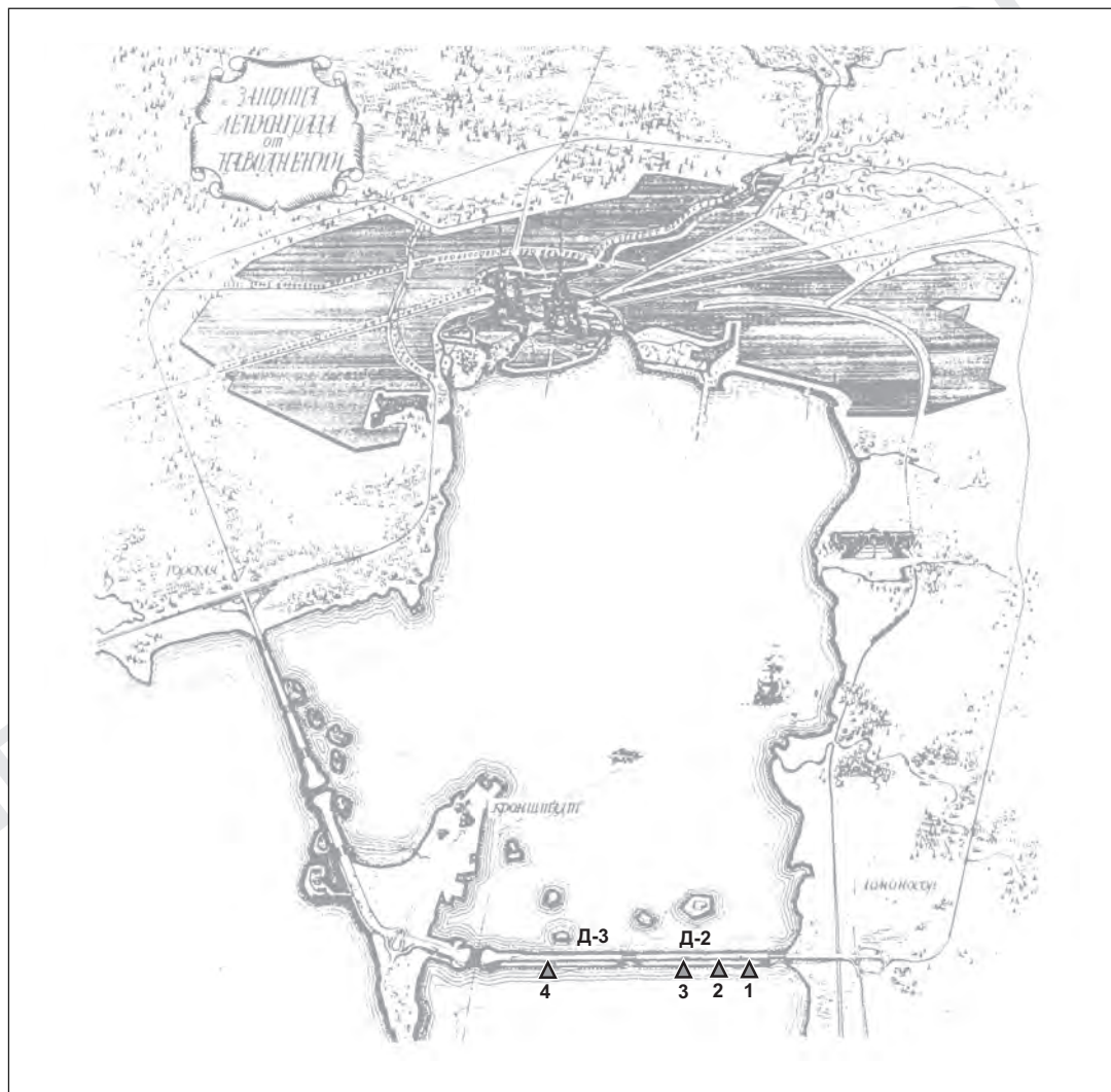
Рис. 3.3. Схема сооружений защиты Санкт-Петербурга от наводнений: Д-2 — номер дамбы; 1...4 — номера опытных полигонов
