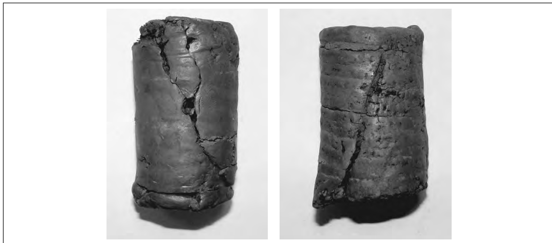
Рис. 6.27. Характерные виды разрушения образцов слоя текучих суглинков, отобранных вручную из котлована
