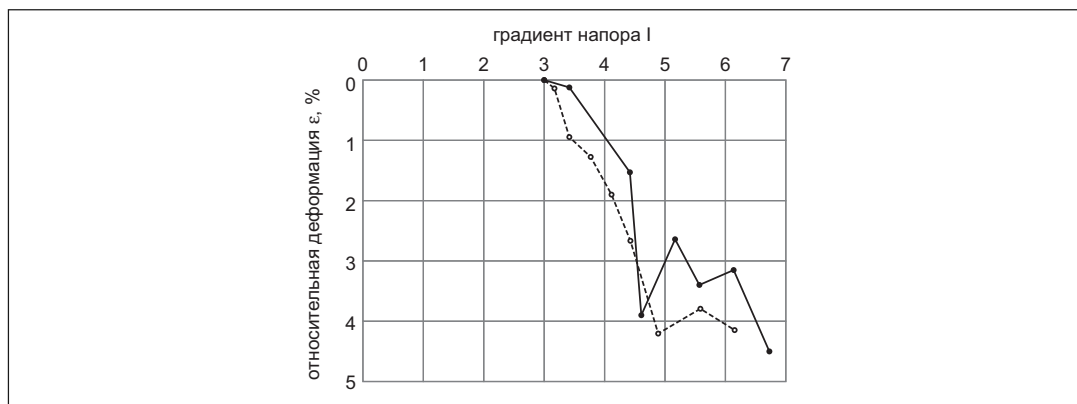
Рис. 5.2. Графики зависимости относительной деформации \epsilon от градиента напора, вызванного приложением внешней нагрузки (экспликацию см. на рис. 5.1)
