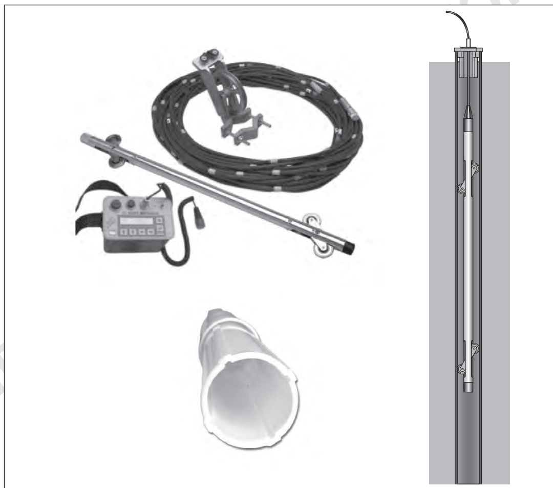
Рис. 3.2. Инклинометр: общий вид — зонд инклинометра, мерный кабель, устройство для считывания данных; профиль обсадной трубы; зонд инклинометра в обсадной трубе
